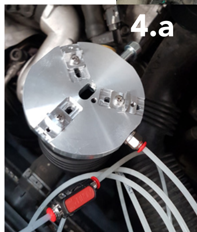
Robinet d'alimentation sur le kit MT424 en position ouverte - la tête de pulvérisation est en bonne position sur la durite de filtre à air
